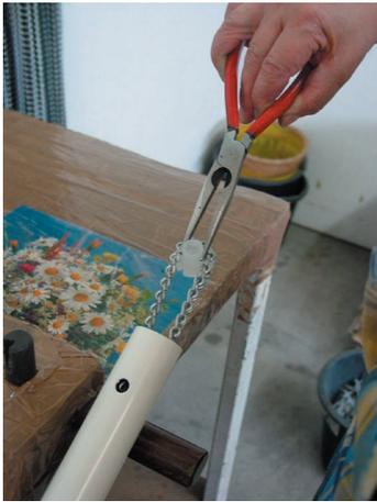
1. Rohr schräg stellen. Kette mit Zahnrädern von oben einführen, **mit den Ösen der Kette nach außen**. Zum besseren Halt des Zahnrades die Zange mit Klebeband umwickeln.
