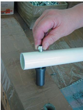
5. Achse des Mitnehmers durch die zweite Bohrung schieben und verschrauben.
